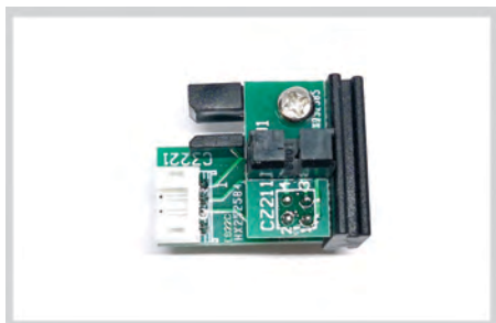
LS/K-264 SENSOR OPTICO, PARA MAQ. CHINAS
