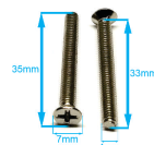
TORNILLO MODELO 308F1B, ALTO 35MM, CABEZA 7MM, CUERDA 4MM, ALTO CUERDA 33MM
