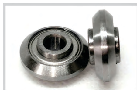
LS/C-224 BALERO PARA BASTIDOR, CENTRO 5MM, DIAMETRO 18MM, ALTURA 8MM
