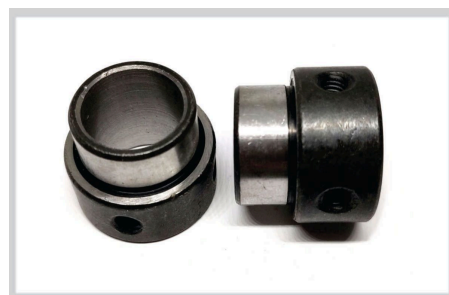
LS/B-1045 BUJE DE FLECHA, B-315, INT. 20MM, EXT. 25MM / ALTO 27 MM
